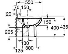
Bidé suspendido. No incluye grifería ni tapa de bidé. Compatible con Sistemas de Instalación Roca Duplo One / Duplo S.
