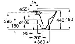
Taza Roca Rimless® con salida dual para inodoro de tanque alto o tanque empotrable. Incluye juego de fijación. Compatible con Sistemas de Instalación Roca Duplo One / Duplo S. Descarga dual 4,5/3L.
