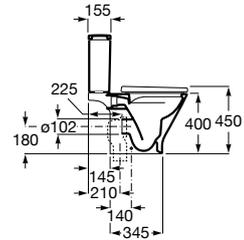
Taza Roca Rimless® compacta adosada a pared con salida dual para inodoro de tanque bajo. Incluye juego de fijación y codo de evacuación.
