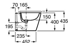
Bidé suspendido. Incluye juego de fijación. No incluye grifería ni tapa de bidé. Compatible con Sistemas de Instalación Roca Duplo One / Duplo S.
