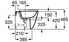
Bidé suspendido con fijaciones ocultas. Incluye juego de fijación. No incluye grifería ni tapa de bidé. Compatible con Sistemas de Instalación Roca Duplo One / Duplo S.
