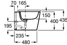
Bidé suspendido. Incluye juego de fijación. No incluye grifería ni tapa de bidé. Compatible con Sistemas de Instalación Roca Duplo One / Duplo S.
