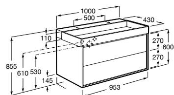
Unik - Conjunto de mueble base de un cajón, estante abierto en la parte inferior y lavabo con dos orificios para grifería. No incluye grifería.
