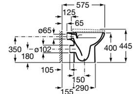
Taza con salida vertical para inodoro de tanque alto, tanque empotrable o fluxor. Incluye juego de fijación y enchufe de unión. Compatible con Sistemas de Instalación Roca Duplo One / Duplo S. Descarga dual 4,5/3L.
