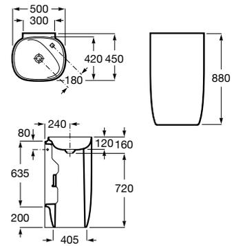
Lavabo de Fineceramic® mural con semipedestal integrado. No incluye grifería. Incluye desagüe universal con tapón cerámico Ø 72 mm.
