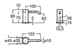
Dispensador electrónico de jabón o gel hidroalcohólico con sensor Touchless de repisa. Alimentación con conexión a la red (100-240 V). Incluye fuente de alimentación.
