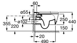
Taza Roca Rimless® suspendida compacta. Incluye juego de fijación. Compatible con Sistemas de Instalación Roca Duplo One / Duplo S. Descarga dual 4,5/3L.
