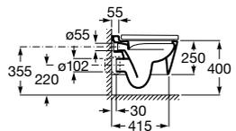
Taza Roca Rimless® adosada a pared con salida dual para inodoro de tanque alto o tanque empotrable. Incluye juego de fijación. Compatible con Sistemas de Instalación Roca Duplo One / Duplo S. Descarga dual 4,5/3L.
