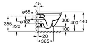
Taza Roca Rimless® suspendida compacta con fijaciones ocultas. Compatible con Sistemas de Instalación Roca Duplo One / Duplo S. Descarga dual 4,5/3L.
