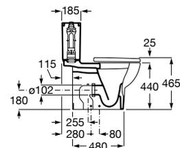
Taza Roca Rimless® adosada a pared compacta con salida dual para inodoro de tanque bajo. Incluye juego de fijación, codo de evacuación y fijación de codo a pared.
