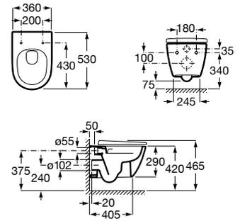
Taza Roca Rimless® suspendida compacta con fijaciones ocultas. Incluye juego de fijación. Compatible con Sistemas de Instalación Roca Duplo One / Duplo S. Descarga dual 4,5/3L.
