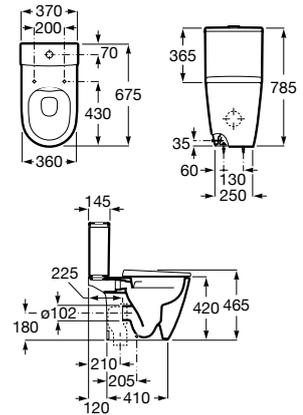
Taza Roca Rimless® adosada a pared compacta con salida dual para inodoro de tanque bajo. Incluye juego de fijación y codo de evacuación.
