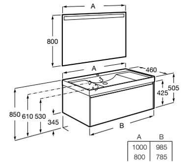
Unik - Conjunto de mueble base de un cajón y lavabo de Fineceramic® a la derecha/izquierda. No incluye grifería.
