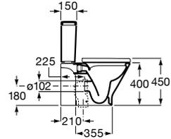
Taza Roca Rimless® altura Comfort adosada a pared con salida dual para inodoro de tanque bajo. Incluye juego de fijación y codo de evacuación.
