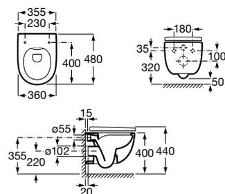
Taza Roca Rimless® adosada a pared compacta con salida dual para inodoro de tanque alto o tanque empotrable. Incluye juego de fijación, codo de evacuación y fijación de codo a pared. Compatible con Sistemas de Instalación Roca Duplo One / Duplo S. Descarga dual 4,5/3L.
