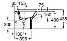
Bidé suspendido. Incluye fijaciones ocultas. No incluye grifería ni tapa de bidé. Compatible con Sistemas de Instalación Roca Duplo One / Duplo S.
