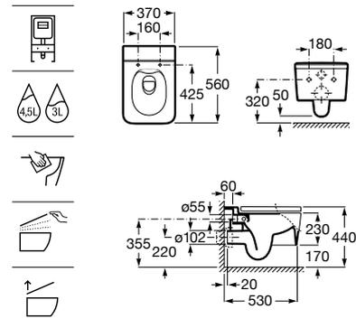
Taza Roca Rimless® adosada a pared con salida dual para inodoro de tanque alto o tanque empotrable. Incluye juego de fijación. Compatible con Sistemas de Instalación Roca Duplo One / Duplo S. Descarga dual 4,5/3L.
