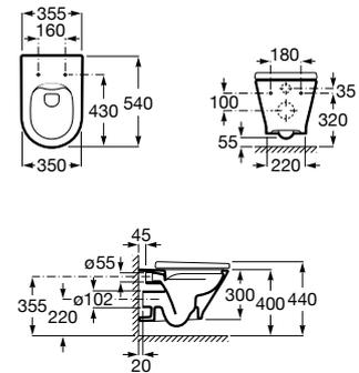
Taza Roca Rimless® suspendida compacta con fijaciones ocultas. Compatible con Sistemas de Instalación Roca Duplo One / Duplo S. Descarga dual 4,5/3L.
