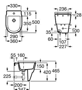
Bidé suspendido. Incluye juego de fijación. No incluye grifería ni tapa de bidé. Compatible con Sistemas de Instalación Roca Duplo One / Duplo S.
