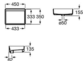
Taza Roca Rimless® adosada a pared con salida dual para inodoro de tanque bajo. Incluye juego de fijación y codo de evacuación.
