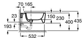
Taza Roca Rimless® adosada a pared con salida dual para inodoro de tanque bajo. Incluye juego de fijación y codo de evacuación.
