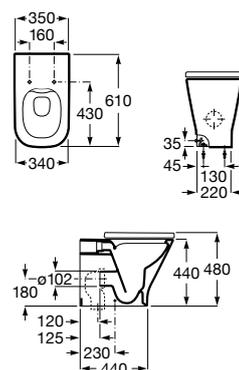
Taza Roca Rimless® para inodoro de tanque alto o tanque empotrable. Incluye juego de fijación. Compatible con Sistemas de Instalación Roca Duplo One / Duplo S. Descarga dual 4,5/3L.
