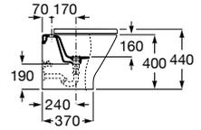
Bidé suspendido con fijaciones ocultas. No incluye grifería ni tapa de bidé. Compatible con Sistemas de Instalación Roca Duplo One / Duplo S.
