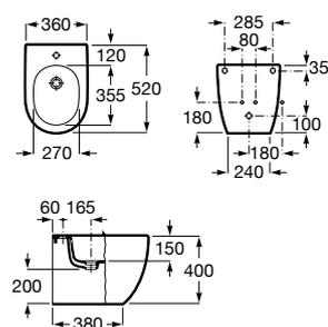
Bidé suspendido con fijaciones ocultas. No incluye grifería ni tapa de bidé. Compatible con Sistemas de Instalación Roca Duplo One / Duplo S.
