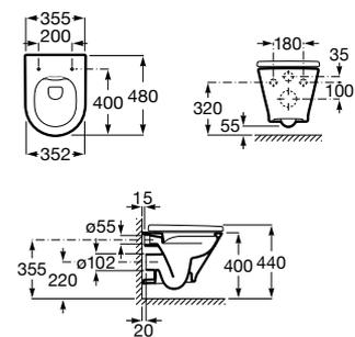
Taza Roca Rimless® altura Comfort para inodoro de tanque alto o tanque empotrable. Incluye juego de fijación. Compatible con Sistemas de Instalación Roca Duplo One / Duplo S. Descarga dual 4,5/3L.
