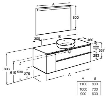
Conjunto de mueble base asimétrico de dos cajones y una puerta para lavabo de sobre encimera a mano derecha/izquierda y espejo Eidos. No incluye lavabo ni grifería.
