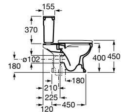
Taza Roca Rimless® con salida dual para inodoro de tanque alto o tanque empotrable. Incluye juego de fijación. Compatible con Sistemas de Instalación Roca Duplo One / Duplo S. Descarga dual 4,5/3L.
