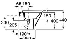
Bidé suspendido con fijaciones ocultas. No incluye grifería ni tapa de bidé. Compatible con Sistemas de Instalación Roca Duplo One / Duplo S.
