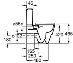
Taza Roca Rimless® con salida dual para inodoro de tanque alto o tanque empotrable. Incluye juego de fijación. Compatible con Sistemas de Instalación Roca Duplo One / Duplo S. Descarga dual 4,5/3L.
