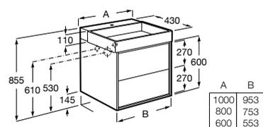
Unik - Conjunto de mueble base de un cajón, estante abierto en la parte inferior y lavabo con un orificio para la grifería. No incluye grifería.
