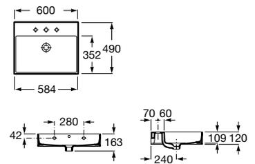
Lavabo de Fineceramic® de sobre encimera. No incluye grifería. Incluye desagüe universal con tapón fijo abierto cerámico de Ø72 mm.
