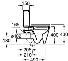
Taza Roca Rimless® suspendida. Incluye juego de fijación. Compatible con Sistemas de Instalación Roca Duplo One / Duplo S. Descarga dual 4,5/3L.
