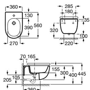
Bidé suspendido compacto. No incluye grifería ni tapa de bidé. Compatible con Sistemas de Instalación Roca Duplo One / Duplo S.
