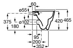
Taza Roca Rimless® suspendida con fijaciones ocultas. Incluye juego de fijación. Compatible con Sistemas de Instalación Roca Duplo One / Duplo S. Descarga dual 4,5/3L.
