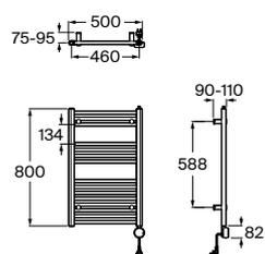
Toallero eléctrico de acero. Incluye termostato con 3 funciones: 4 niveles de temperatura ajustables, temporizador de potencia (2h) y temporizador de potencia con auto-off. Potencia de 500W. Dispone de protección frost (bajas temperaturas) y bajo consumo durante modo reposo. Incluye kit de montaje.
