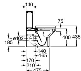
Taza Roca Rimless® suspendida con fijaciones ocultas. Incluye juego de fijación. Compatible con Sistemas de Instalación Roca Duplo One / Duplo S. Descarga dual 4,5/3L.
