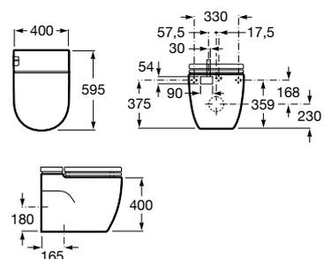
Taza altura Comfort adosada a pared con salida dual para inodoro de tanque bajo. Incluye juego de fijación y codo de evacuación.
