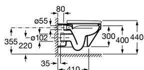
Taza adosada a pared compacta con salida dual para inodoro de tanque alto, tanque empotrable o fluxor. Incluye juego de fijación y enchufe de unión. Compatible con Sistemas de Instalación Roca Duplo One / Duplo S\*. Descarga dual 4,5/3L.
