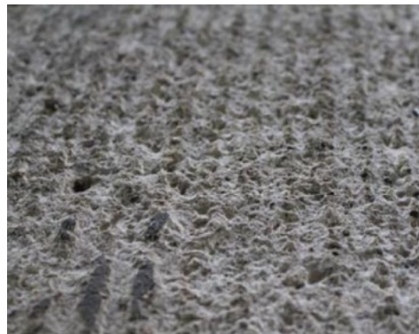
Ejemplo de preparación de superficie grado GSP 9
