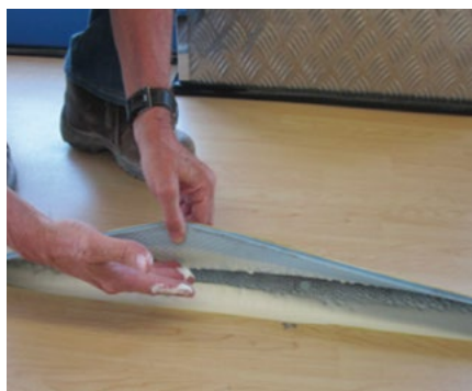
Afectaciones en el adhesivo
